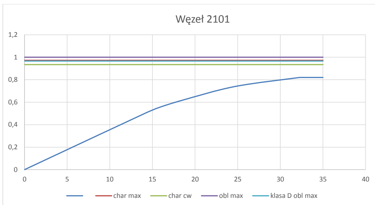
Rys. 10.1.9. Wykres siła-przemieszczenie. (mnożnik dla obliczeniowej siły max w linii dla Cw+kl A
