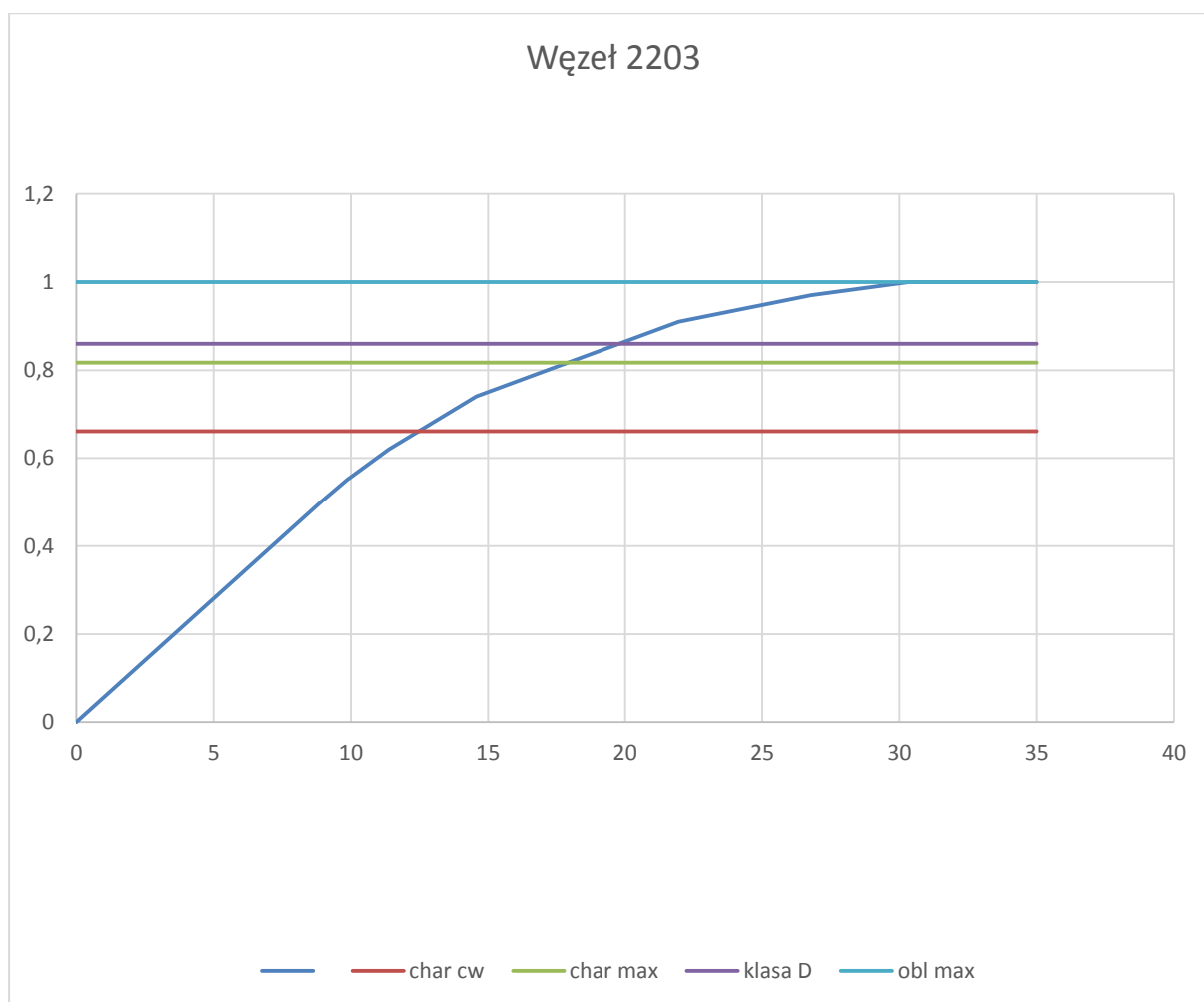
Rys. 10.11.9. Wykres siła-przemieszczenie (mnożnik dla obliczeniowej siły max w linii dla Cw+kl A)
