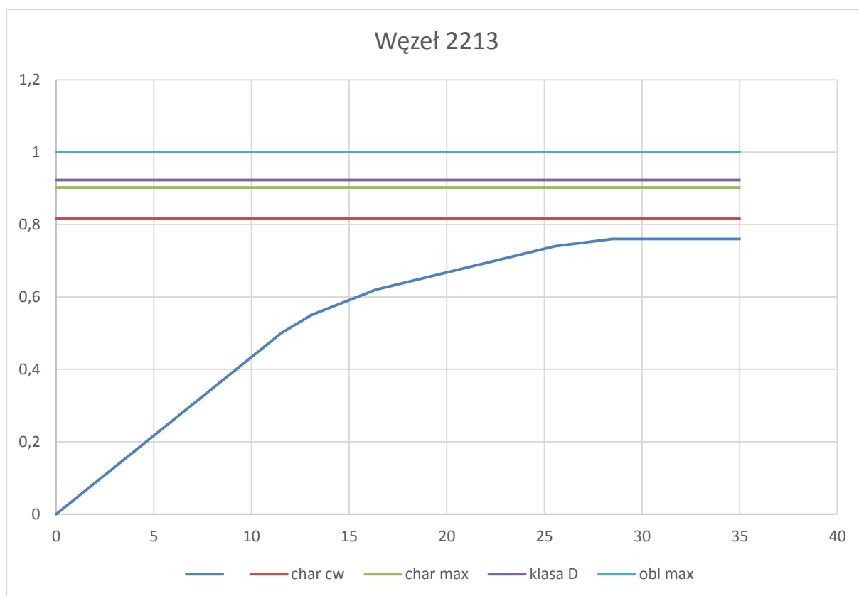
Rys. 10.15.9. Wykres siła-przemieszczenie (mnożnik dla obliczeniowej siły max w linii dla Cw+kl A).
