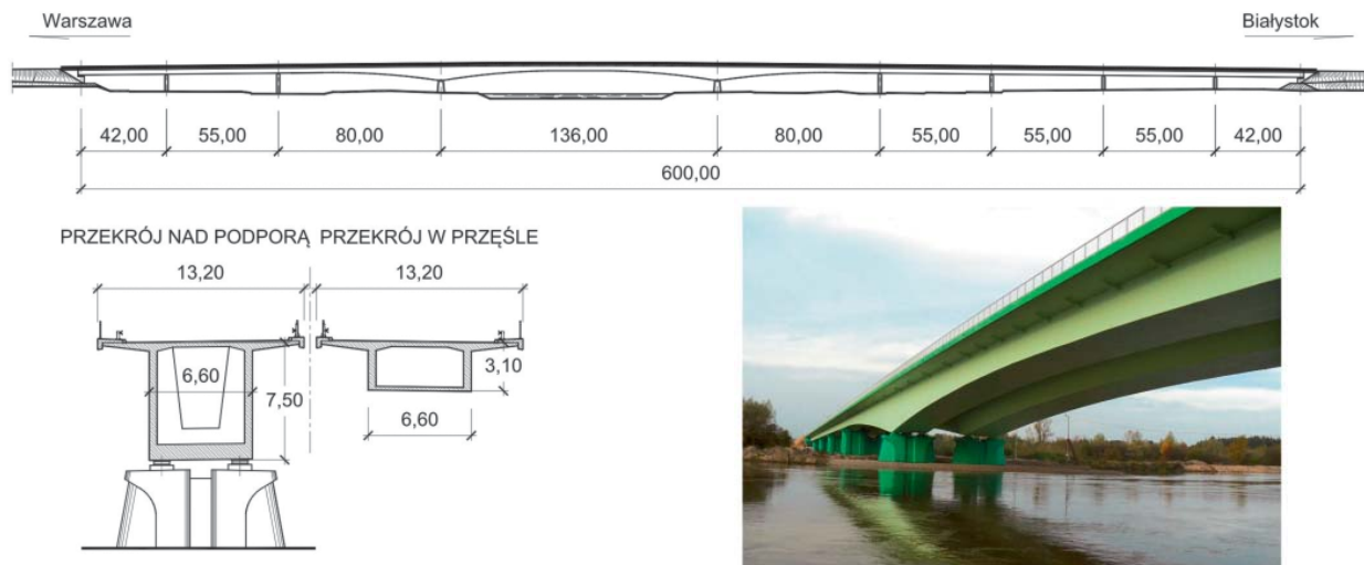
Rys. 1. | Belkowy most skrzynkowy z betonu sprężonego przez Bug w Wyszkowie (2008). Projekt – K. Nagórko, W. Kujawski; realizacja – PRM Mosty Łódź S.A. [15]
