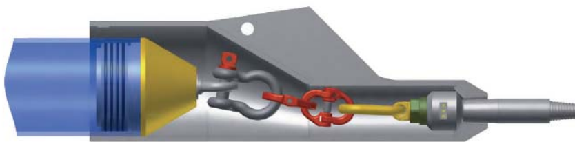
FOT. 5. Zestaw T47 z zasilaczem hydraulicznym, żerdziami roboczymi, głowicą tnącą oraz ciągnącą RYS. 6. Schemat połączeń głowicy roboczej, ciągnącej i rurociągu FOT. 6. Wymiana betonowego rurociągu \varnothing 900\text{mm} na rurę PE \varnothing 1000 w Kanadzie FOT. 7. Pipebuster T400 w wykopie startowym
