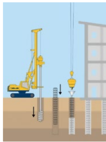
Wykonywanie pali VDW
