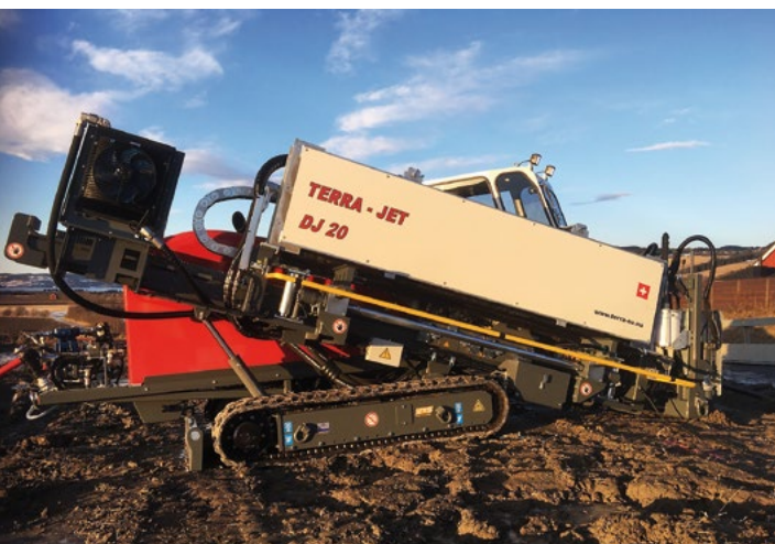
FOT. 4. | Wiercenie pilotowe z kątem wejścia około 24° (pochylenie maszyny 45%) przy wsparciu lemisza tylnego
