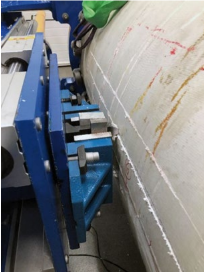
FOT. 1. | Próbkę rury pokryta warstwą laminatu w trakcie testów na stanowisku badawczym
