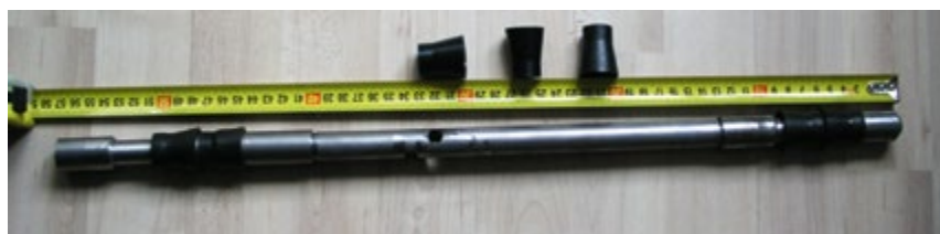
FOT. 2. | Przewody do iniekcji niskociśnieniowych z zaworami opaskowymi na długości
