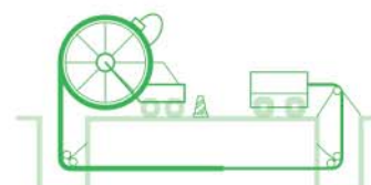
SIEĆ WODOCIĄGOWA TECHNOLOGIA CLOSE FIT
