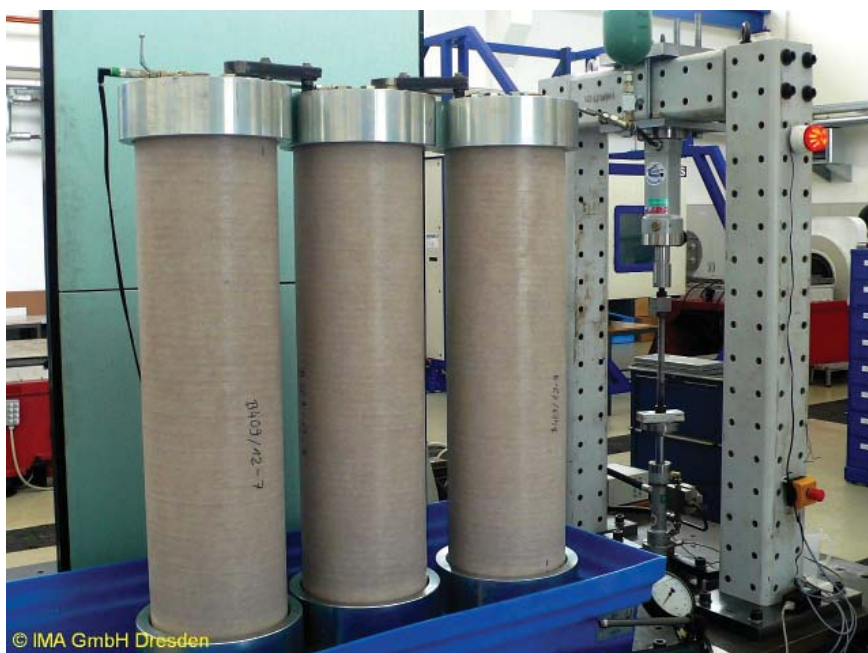
FOT. 2. Ustawienie testowe w IMA Dresden zgodne z ISO 15306 [11]
